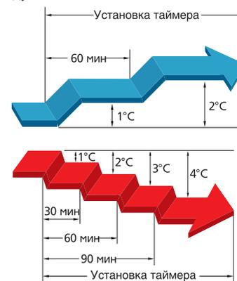
**В режиме охлаждения:** температурная уставка автоматически повышается на 1 °C каждый час (но не более чем на 2 °C).
